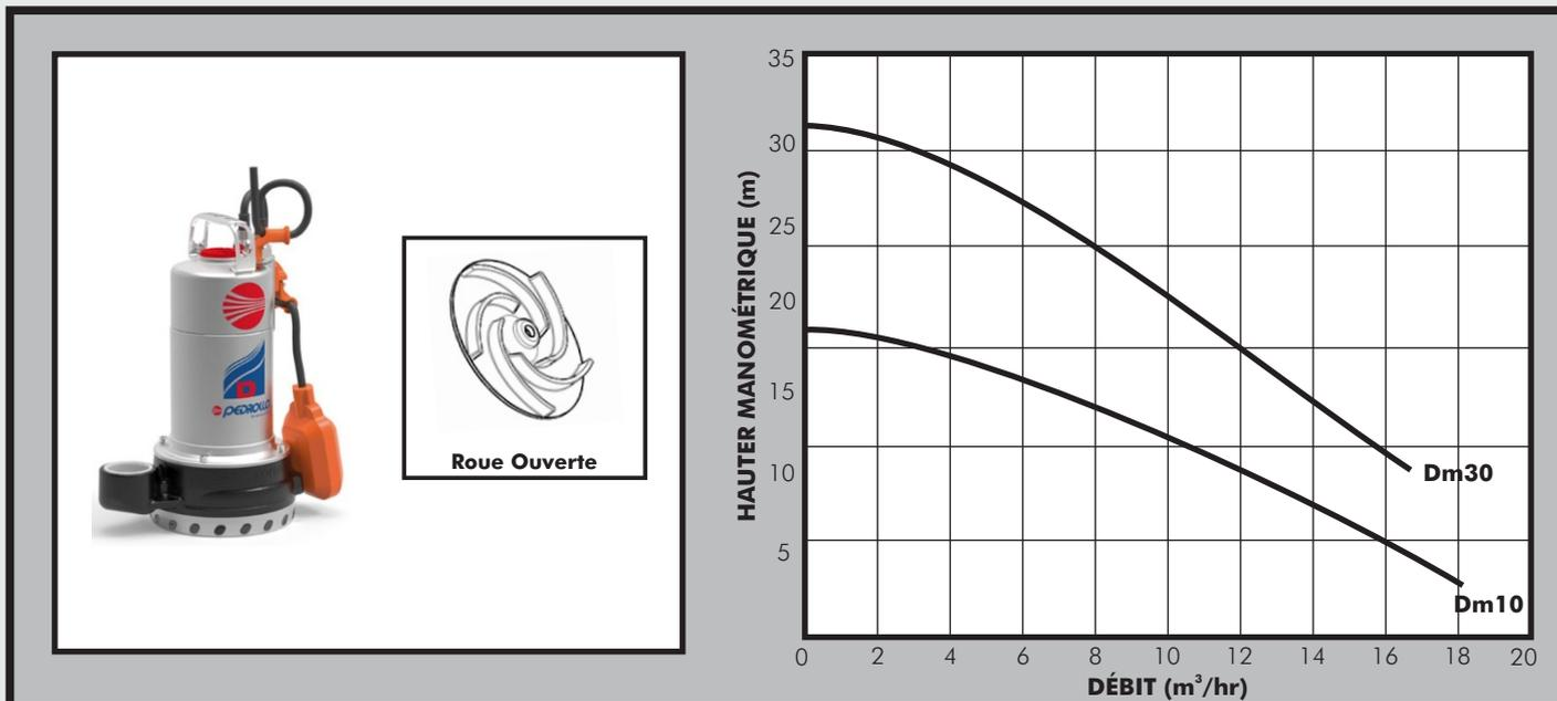
**POMPE** Les pompes centrifuges submersibles de drainage de la série Pedrollo D sont spécifiquement conçues pour fonctionner dans des eaux usées légèrement chargées d'impuretés. Elles sont équipées de roues ouvertes pour des tâches plus légères et sont plus adaptées au drainage des zones inondées.
