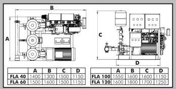
Les groupes de pompage DAYLIFF FLA sont spécialement conçus pour assurer l'alimentation automatique de plusieurs dévidoirs de tuyaux ou de gicleurs dans les installations de lutte contre l'incendie. Les groupes de pompage combinent des pompes d'alimentation diesel et électriques de service parallèle pour assurer la facilité d'entretien dans toutes les conditions, ainsi qu'une pompe jockey pour maintenir la pression du système. Les caractéristiques particulières comprennent:-
